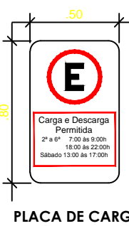
PLACA DE CARGA E DESCARGA - A= 0,40m² SEM ESCALA
