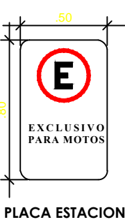
PLACA ESTACIONAMENTO DE MOTOS - A=0,40m² SEM ESCALA
